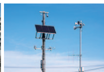
大曲海岸に設置されたネットワークカメラと電力自立システム
