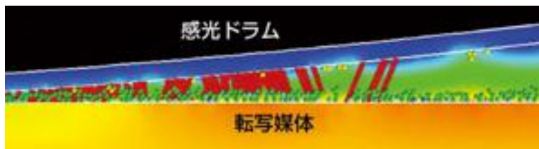
複合機における転写プロセスのシミュレーション例
