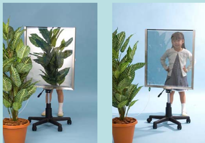
わずかなガスの注入によって反射率を大きく 変えることのできる調光ガラス窓 (左: 鏡状態、右: 透明状態)
