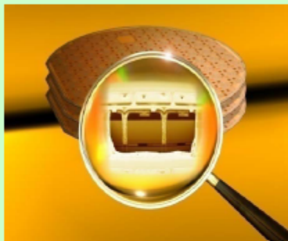
センサとプロセッサの積層イメージ (2008 ITRS Conference 資料より)
