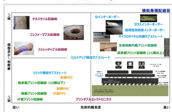
【図10:プリント配線板の技術マップ】
