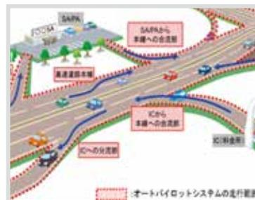
単一車線内やレーンチェンジを含む、自動車専用道におけるレベル3自動運転システムの各種機能要件や評価方法を標準化。
