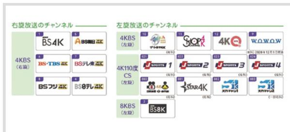
従来のBS・110度CSアンテナは、右旋放送のみに対応しています。そのため、BS右旋で放送される4K放送は受信できますが、BS左旋・110度CS左旋で放送される4K・8K放送は受信できません。全ての新4K8K衛星放送をお楽しみいただくためには、右旋と左旋の両方に対応したアンテナへ交換する必要があります。さらに、宅内伝送に使用されている分配器、分波器、ブースタ等もBS・110度CS右左旋放送受信帯域(1032～3224MHz)に対応した機器へ交換する必要があります。
