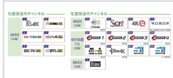
従来のBS・110度CSアンテナは、右旋放送のみに対応しています。そのため、BS右旋で放送される4K放送は受信できますが、BS左旋・110度CS左旋で放送される4K・8K放送は受信できません。全ての新4K8K衛星放送をお楽しみいただくためには、右旋と左旋の両方にに対応したアンテナへ交換する必要があります。さらに、室内伝送に使用されている分配器、分波器、ブースタ等もBS・110度CS右左旋放送受信帯域(1032～3224MHz)に対応した機器へ交換する必要があります。
