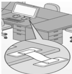
液晶モニターの台座をストラップ式器具で固定する。
