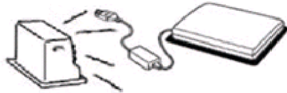
暖房機の熱が直接あたる場所
