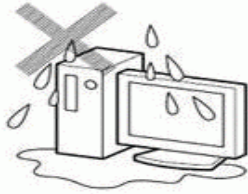
風呂場、調理場、加湿器の近くなど 水、湿気の多い場所
