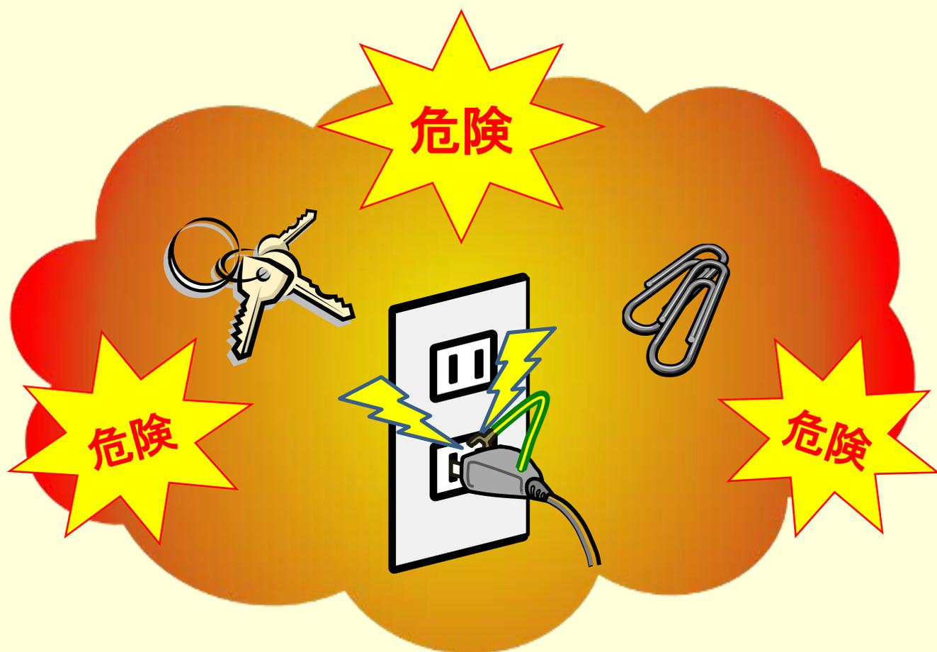
電源プラグをコンセントやテーブルタップに差し込む際、金属製のアクセサリやストラップ、鍵、クリップ、電源プラグ付属のアース端子等を挟み込むと、電源プラグの刃の間がショートし、火花が発生する場合があります、やけどや火災につながるおそれがあります。
