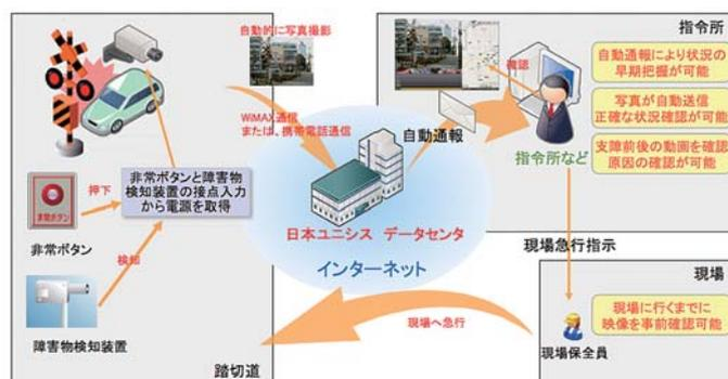
非常ボタンが押されたときや障害物検知装置作動時に自動発報し、指令所にそのときの画像を送信する。
