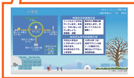
画面には、発電状況や蓄電残量、買電している電力量などその施設のエネルギー情報が掲載されている。また、お知らせ画面を活用して教員が注意喚起を行っているほか、児童からのお知らせも掲載するなど、コミュニケーションツールとしても用いている。
