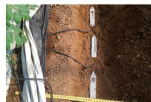
灌水チューブ孔を中心にチューブに沿って配置した例。
