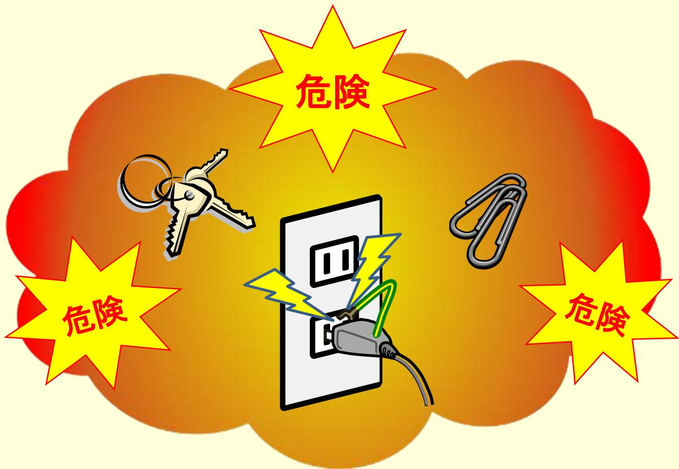
電源プラグをコンセントやテーブルタップに差し込む際、金属製のアクセサリーやストラップ、鍵、クリップ、電源プラグ付属のアース端子等を挟み込むと、電源プラグの刃の間がショートし、火花が発生する場合があり、やけどや火災につながるおそれがあります。
